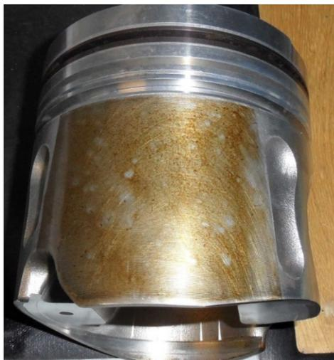
**Рис. 3. Поршень с антифрикционным покрытием на базе дихалькогенидов вольфрама (по окончании длительных испытаний)**
