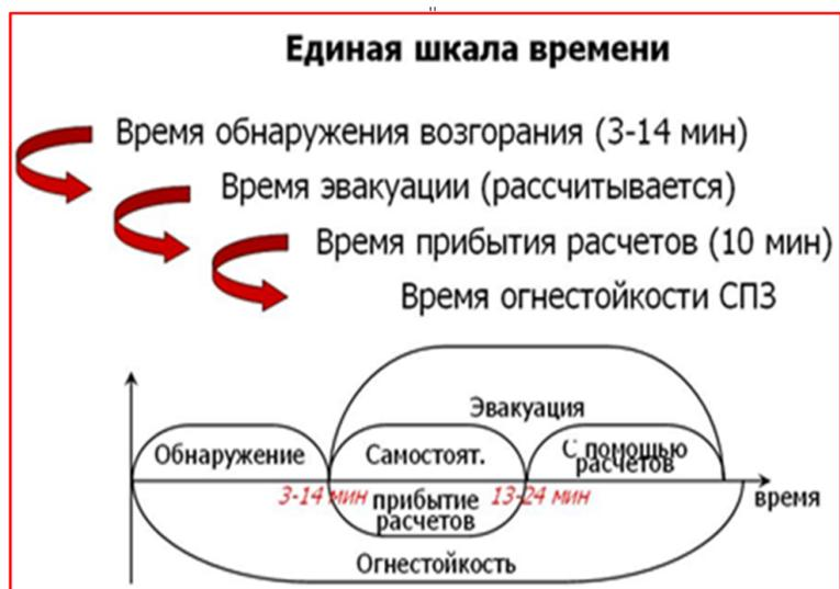
Рис. Шкала времени обнаружения и реагирования на сигнал «ПОЖАР»
